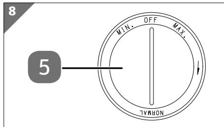
Le réglage du thermostat 5 a pour effet de régler automatiquement la température dans le congélateur.
