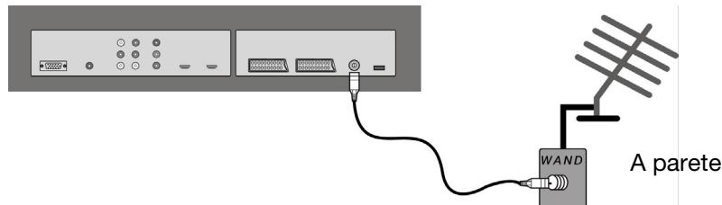
Per collegare l'antenna di casa oppure l'impianto via cavo connettere la presa dell'antenna e la TV a LCD con il cavo dell'antenna a doppia schermatura.
