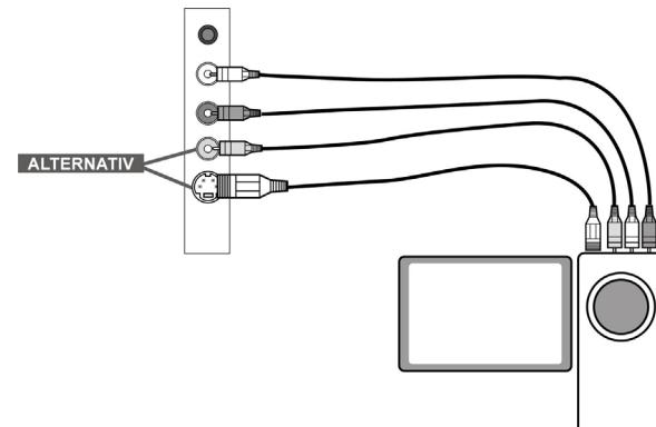
Verbinden Sie den Camcorder nicht gleichzeitig mit den Anschlüssen **S-VIDEO** und **VIDEO IN**; dies kann zu Bildstörungen führen.
