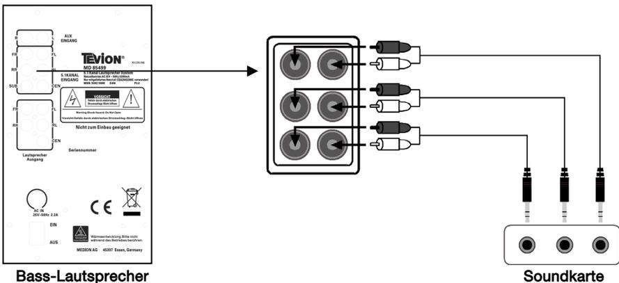
[Abb.: Anschluss 5.1 Kanal Ausgang an Soundkarte]
