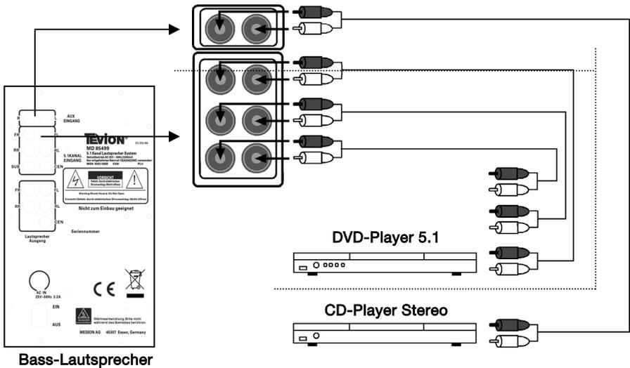
[Abb.: Anschluss 5.1 Kanal Eingang und AUX Eingang]
